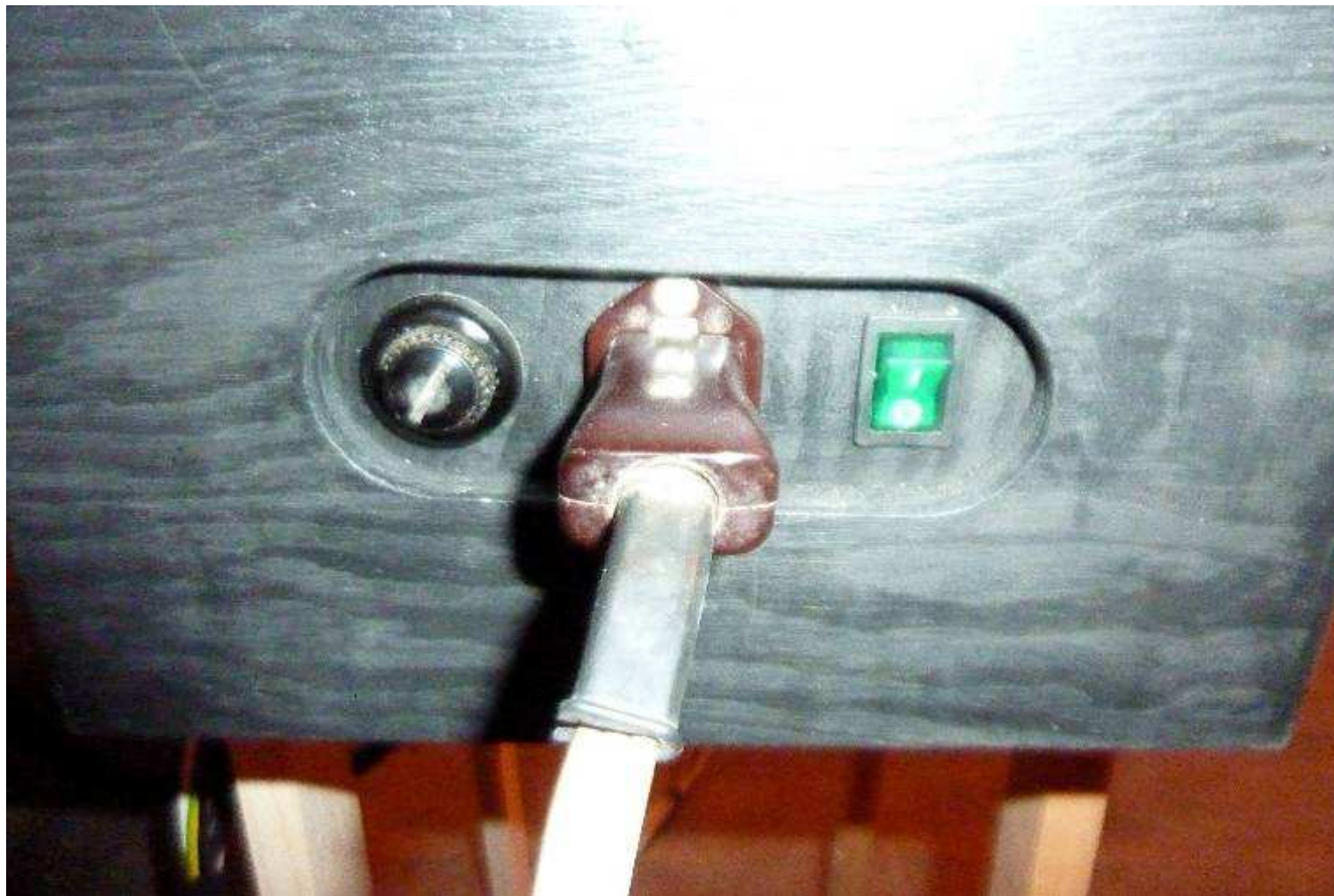
Klasická trojkombinace na straně 220V – pojistkové pouzdro, přívod a prosvícený vypínač.
