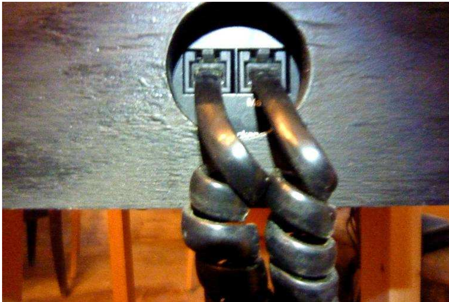
Detail konektorů zesilovače pro připojení ovladačů – jedna díra o průměru 30mm a zesilovač usazený přesně proti ní.
